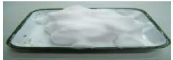
写真 1 発泡させた AE 剤の空気泡
