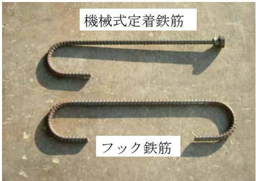
写真-1 機械式定着鉄筋およびフック鉄筋
