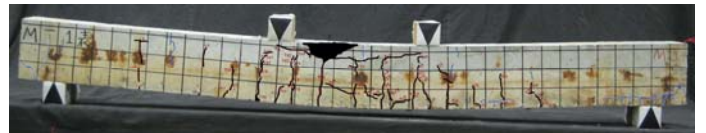
写真 3 M 供試体 (通電期間 12 日)
