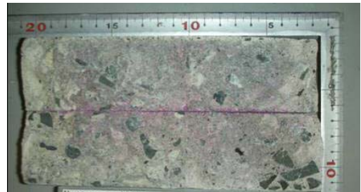
写真-2 ひび割れ面の中性化 (case1-PL-5% 8 週)
