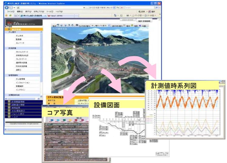
図-4 3次元空間を基盤とした情報管理システム
