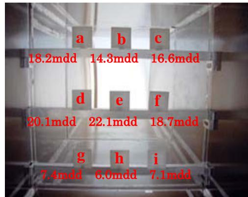
図-2 各供試体設置位置における飛来塩分量
