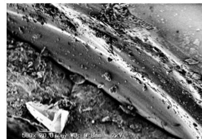
写真-2 材齢16日での反応生成物
