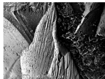
写真-3 材齢20日での反応生成物
