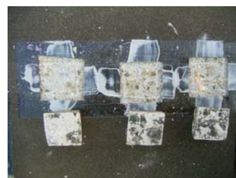
写真-8 床版面②破壊状況
