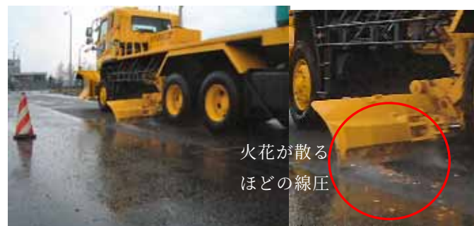
写真-3 除雪車を用いた耐摩耗試験
