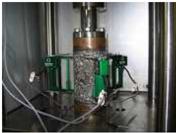
図-1 push-pull 一軸疲労試験装置
