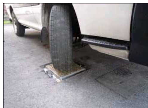
写真-2 実車据え切り試験状況
