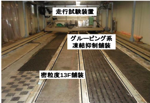
写真 2 走行試験装置と試験路面
