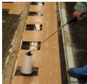
写真3 氷板路面の作製
