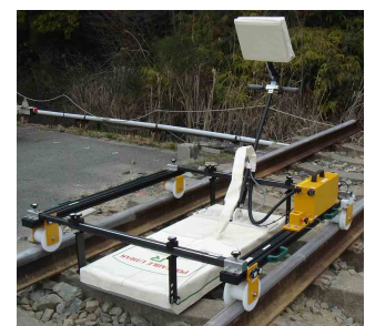
写真2 導入した可搬型探査装置
