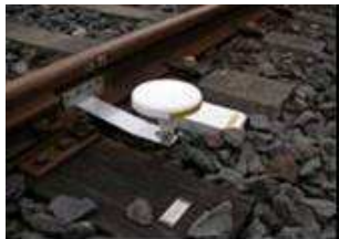
図-5 ロングレール取付け方法
