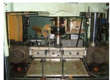
図 2 継目曲げ疲労試験の状況
