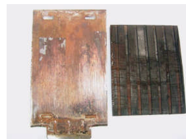
写真-1 接着が剥がれた鋼板付軌道パッド
