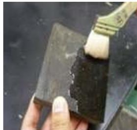
図5 試験体の作成
