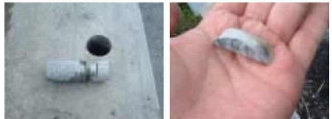
図 6 切削コア(左)と切断した鉄筋(右)
