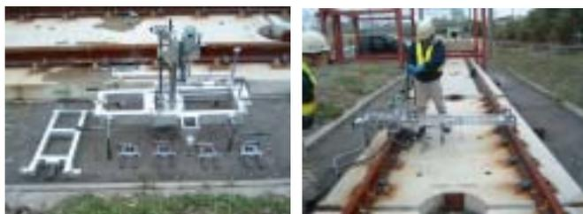
図 4 オンレール式スラブ穿孔機械
