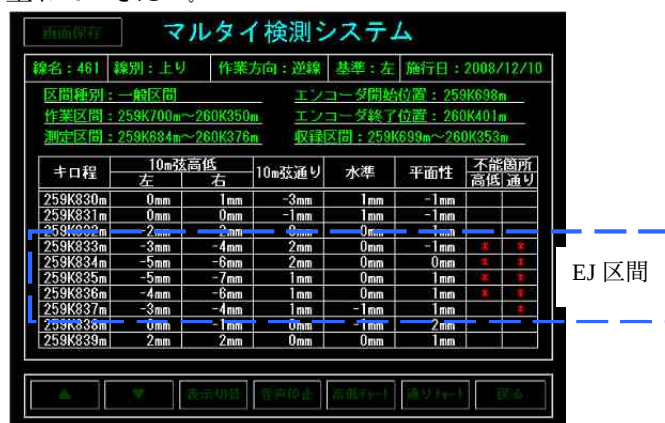
図-6 仕上がり検測データ (EJ 取付け)
