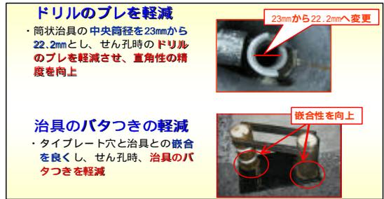
(図-5)筒状穿孔治具の改良
