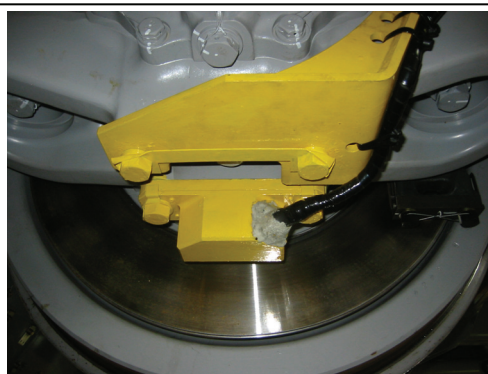
図 2 軸箱加速度取付状況
