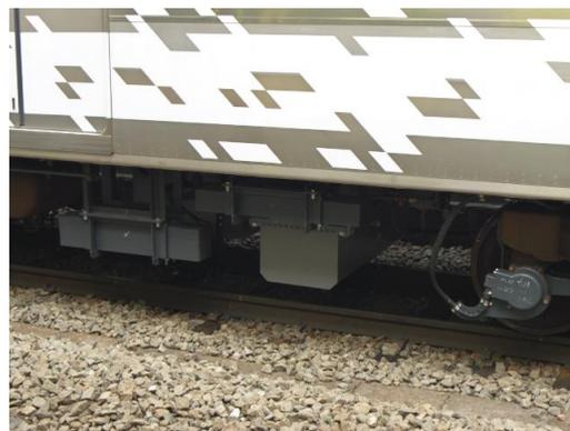
図1 車体装架型慣性正矢軌道検測装置
