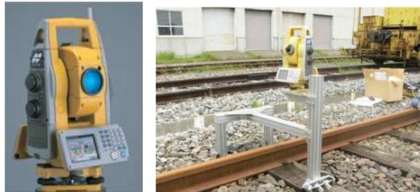
図-2 レーザートランジット
