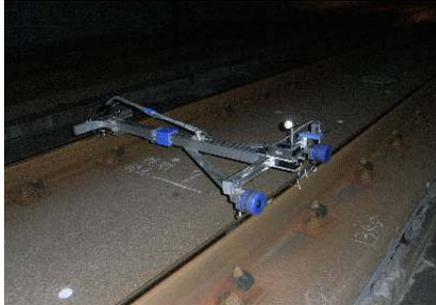
図-3 移動式ターゲット治具
