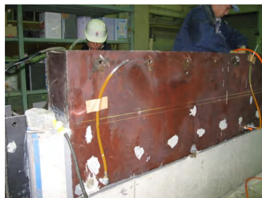
写真-2 着色水によるシーリング状況確認試験
