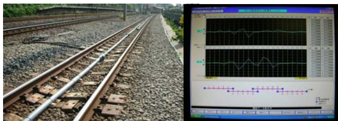
写真-3 自動軌道計測器
