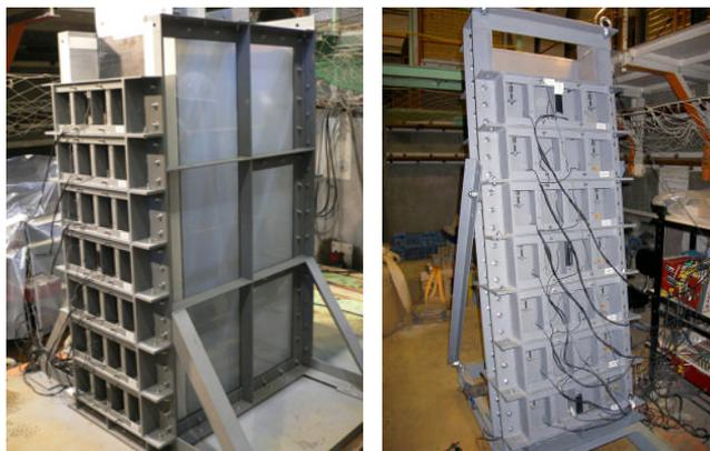
(a) 鉛直土槽 (b) 傾斜土槽
