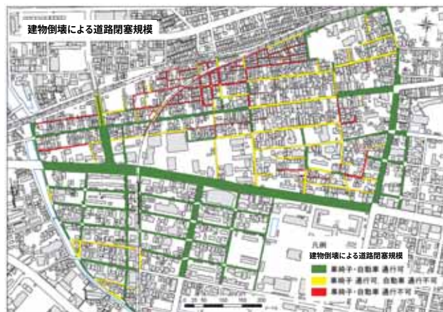
図4. 建物倒壊による道路閉塞規模
