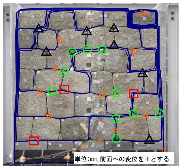
間詰石の変位 △: 抜け落ち, ○: 浮き, □: 圧壊 網掛け: 前方への変位量 35mm 以上の孕み出し領域 図-1 光波測量結果から求めた変位状況
