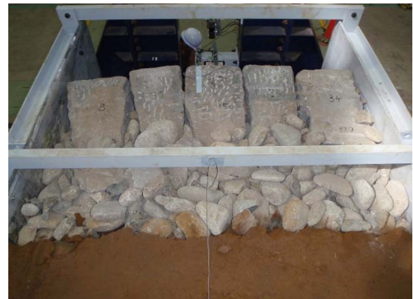
写真-1 実験終了後の石垣変位状況
