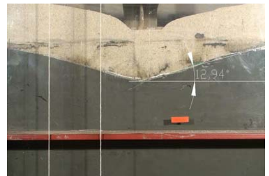
図-4 載荷荷重 19.6 kPa 載荷時に撮影された代表的な表層処理補強材の変形図
