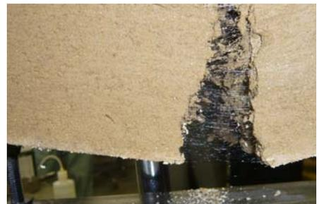
写真-2 試験体破断面状況
