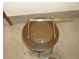
写真-1 テーブルフロー試験
