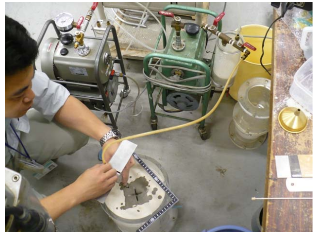
図-3 十字型溝掘削状況
