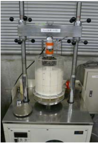
図-2 小型土槽を用いた 鉛直載荷試験状況
