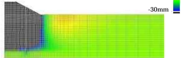
図 - 5 鉛直変位コンター図 (CASE-1)
