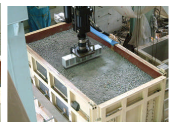
写真 4 輪荷重载荷状況
