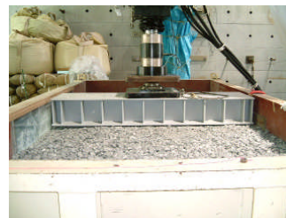
写真 3 静土圧载荷状況
