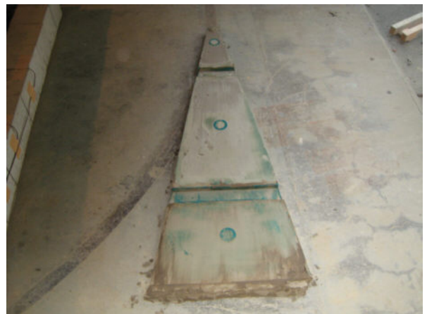
図9 硬化後脱型したグラウトの状況(CASE3)
