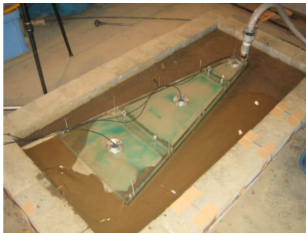
図4 土槽への充填状況
