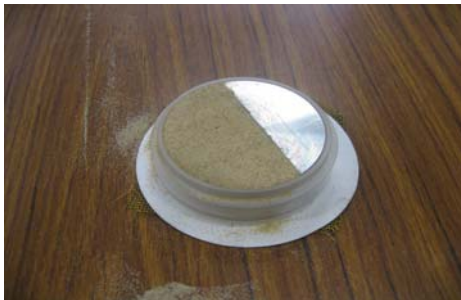
写真 1 アルミ型枠入りモールドと砂
