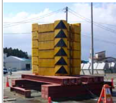
写真 4-1 平板載荷試験状況
