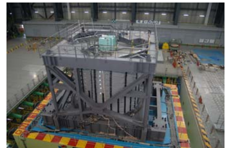
写真-1 Eーディフェンス実験における円筒形せん断土槽実験
