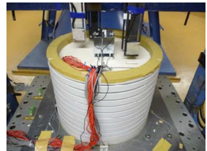
写真-2 遠心振動実験における円筒形せん断土槽実験
