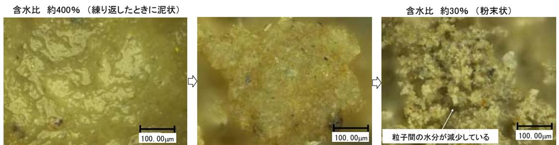
図2 20°Cの風乾過程で撮影した浄水汚泥の顕微鏡写真
