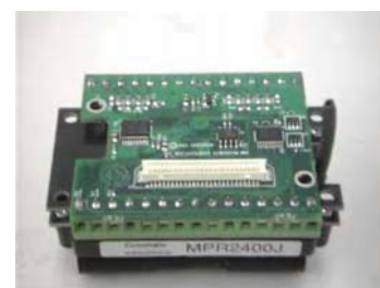
写真-2 外部センサ接続用基板とセンサノード
