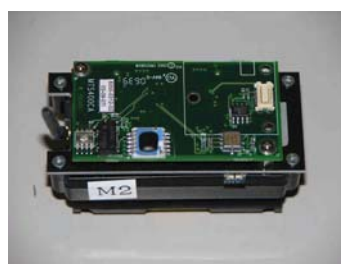
写真-1 気象観測用基板とセンサノード
