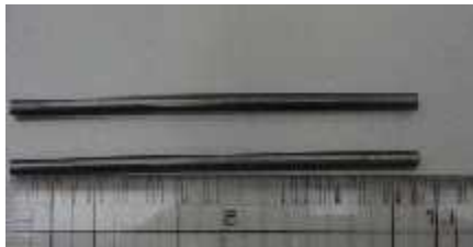
写真 1,カーボン電極（厚さ 2mm、長さ 9.5cm）
