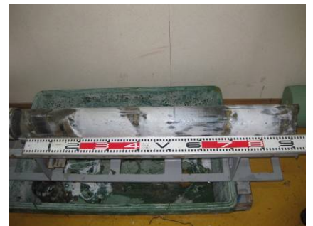
写真-2 コア取り出し後状況(ポリマー除去前)
