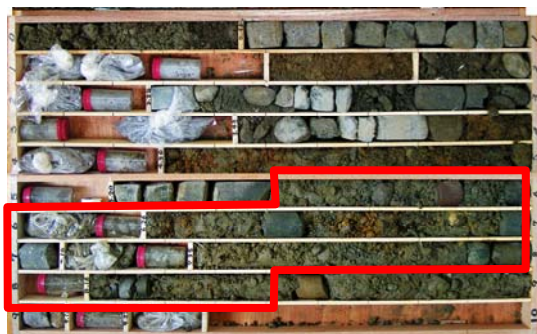
写真-3 ボーリングによるコア (赤枠部分が不攪乱試料採取深度)
