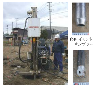
(a)連続打撃動的貫入試験状況 (c)小型ビット
