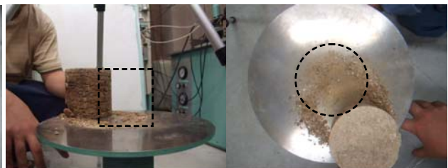
写真-2 吸水⑭供試体 (落下回数 20 回)
