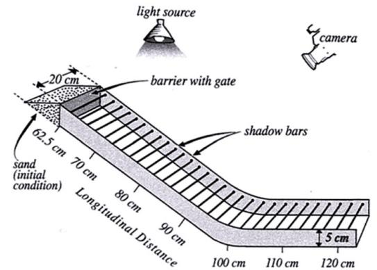
図3 流動実験の概要<sup>2)</sup>
