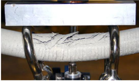
写真-1 杭体破壊状況
