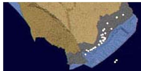
図-2 岩球体の跳ね返り係数を用いた場合の落石停止位置
