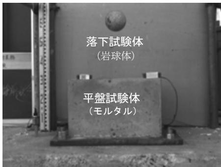
写真-1 屋内実験状況 (自由落下試験)
