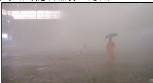
写真-1 実測降雨量 192mm/h での計測状況
