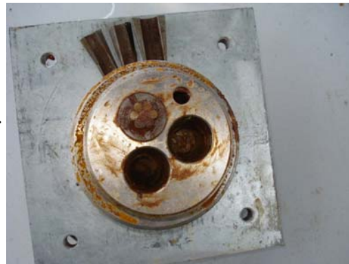
写真-1 ケーブルの引抜き状況
