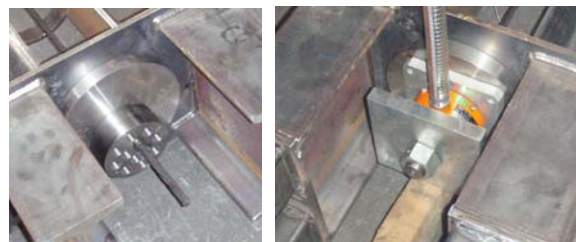
写真-2 くさび式（左）とナット式の定着
