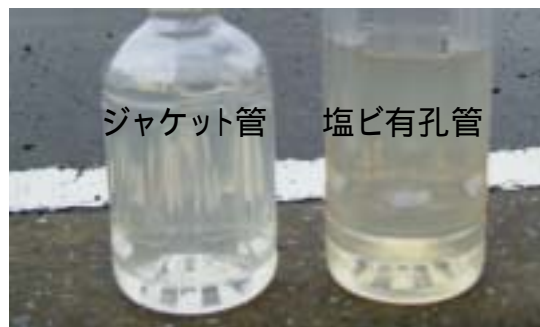
写真-5 施工半年後の排水の濁り
